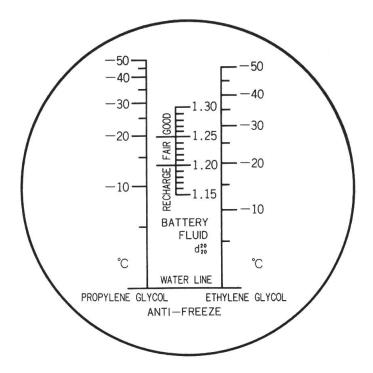
vercle sont importantes parce qu'elles assurent un bon fonctionnement du système de réfrigération. On les examine au moyen d'un appareil de contrôle approprié.
