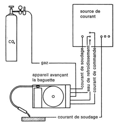
Fig. 4: Représentation schématique du soudage au CO<sub>2</sub>.
