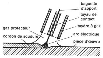
Fig. 3: Représentation schématique de soudage MAG.
