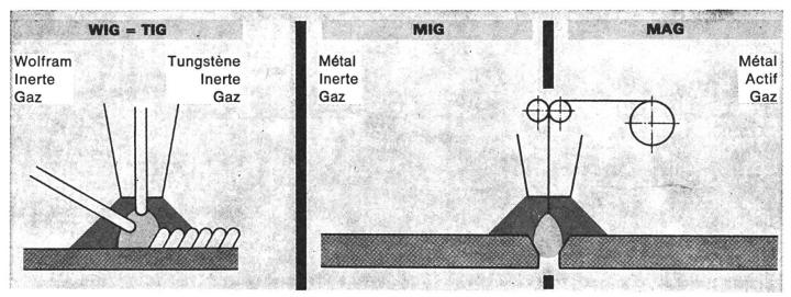
Electrode en tungstène permanente et baguette d'appoint
