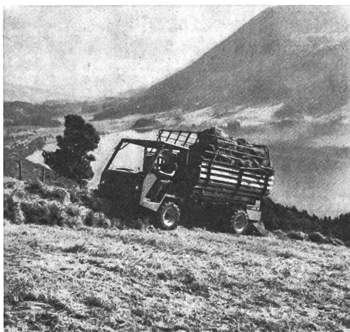
Fig. 1: Le char automoteur représente une machine Précieuse pour l'agriculteur travaillant sur terrains déclives.
