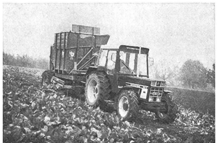
Fig. 7: Procédé de récolte en deux phases et sur deux rangs, avec décolleteuse EGLI munie d'un tâteur à roue et d'une trémie d'arrachage THYREGOD.
