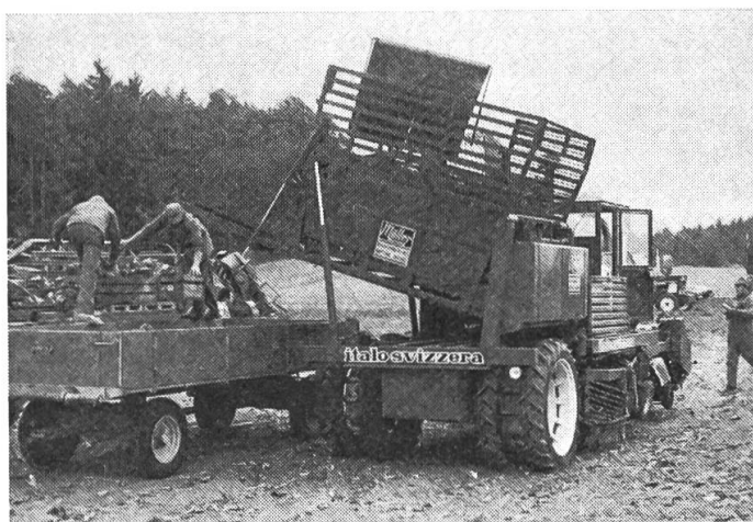
Fig. 2: Cette machine automotrice ITALO-SVIZZERA fut utilisée pour la première fois en Suisse. C'est une récolteuse à deux rangs propulsée et commandée entièrement par des hydromoteurs, comme les modèles à un rang de la marque.
