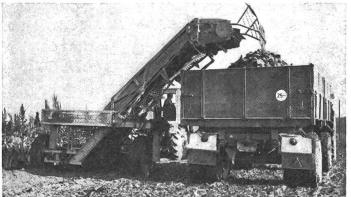
Fig. 4: Décolleteuse-arracheuse et chargeuse à six rangs KLEINE. L'unité de décolletage-arrachage est montée en poupe d'un tracteur lourd avec dispositif
