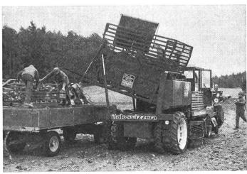
Fig. 2: Cette machine automotrice ITALO-SVIZZERA fut utilisée pour la première fois en Suisse. C'est une récolteuse à deux rangs propulsée et commandée entièrement par des hydromoteurs, comme les modéles à un rang de la marque.
