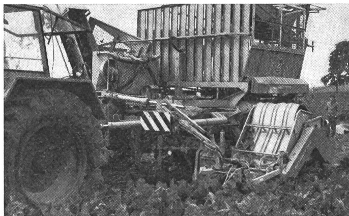
Fig. 3: Récolteuse combinée à deux rangs tractée, de SCHMOTZER, avec décolleteuse munie d'un tâ-teur à roue et élévateur de transbordement à lames. Cette machine traite simultanément quatre rangs de betteraves (photo 1: vue de l'arrière).
