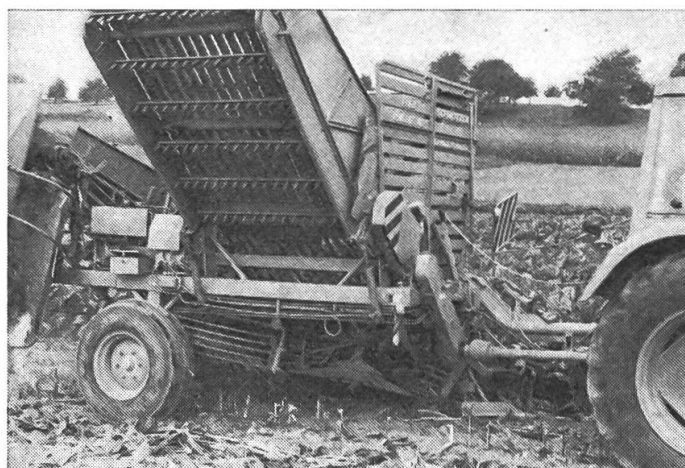
Fig. 6: La récolteuse combinée FRIED F450 est la seule machine à un rang à être équipée de deux cages d'écureuil.
