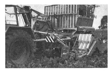
Fig. 3: Récolteuse combinée à deux rangs tractée, de SCHMOTZER, avec décolleteuse munie d'un tâteur à roue et élévateur de transbordement à lames. Cette machine traite simultanément quatre rangs de betteraves (photo 1: vue de l'arrière).
