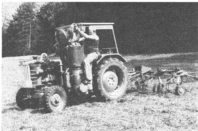
Le tracteur agricole Hürlimann, type D 110, qui a été transformé pour fonctionner au Diesel / gaz de bois. 1 litre de carburant Diesel est remplacé par 4,5 kg de bois.
