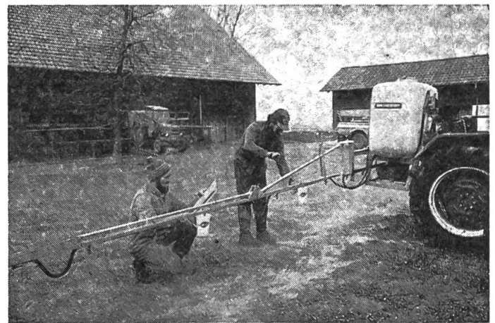
Fig. 5: Le débit de chaque buse est déterminé pendant 20 à 30 secondes. Cette précaution devrait être prise chaque année et tout particulièrement lorsque les surfaces traitées sont considérables. Une formation de brouillard peut être prévenue en poussant une section de tube en plastique sur la buse examinée.
