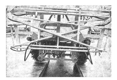
Fig. 8: Deux détails importants souvent négligés: les feux arrières et les clignoteurs. Le plus souvent, ils sont masqués par la cuve de pulvérisateurs portés, et il importe que l'agriculteur y remédie.
