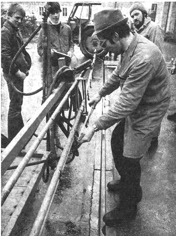
Fig. 2: Le contrôle de l'espacement des buses terminales placées sur des secteurs de rampe contigus fait aussi partie des révisions de pulvérisateurs.
