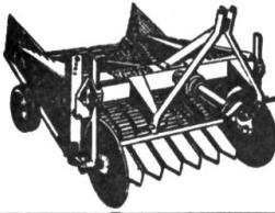
Arracheuse-aligneuse à chaîne cribuleuse 2 rangs **KUXMANN GOLIATH** avec rendement étonnant! Pour la récolte de pommes de terre, betteraves, céleris, carottes, oignons, etc.
