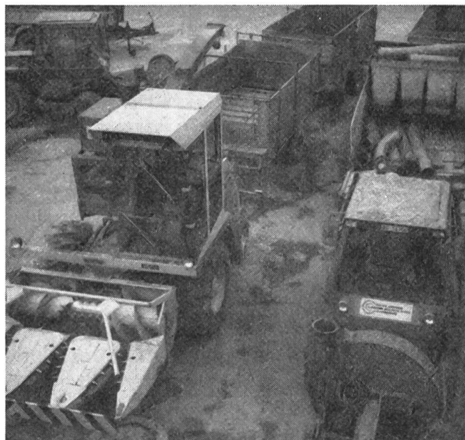
Fig. 3: Une chaîne d'ensilage moderne avec ensileuse automobile à 3 rangs et doseur, prête à être déplacée d'un lieu de travail à un autre. Travail effectué par un entrepreneur ou une COUMA.
