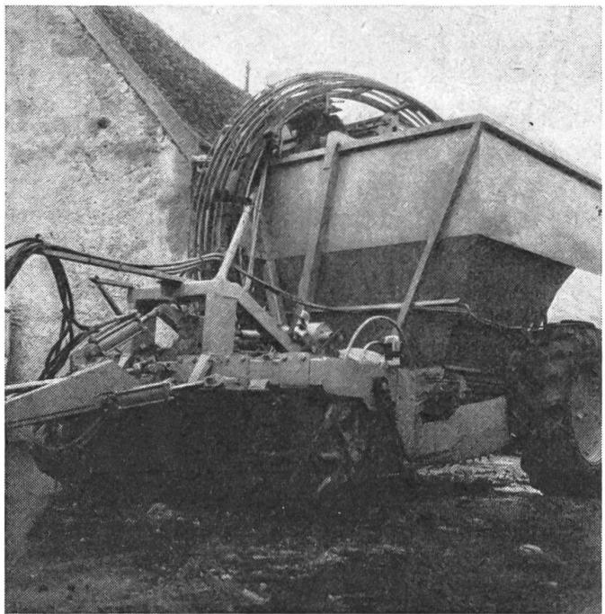
L'encombrement est relativement réduit, largeur hors tout 2,85 m et longueur 4,50 m sous l'attelage pour une hauteur de déversement dans les remorques de 4,10 m. Les flèches signalent les vérins de correction automatique de terrage et alignement.
