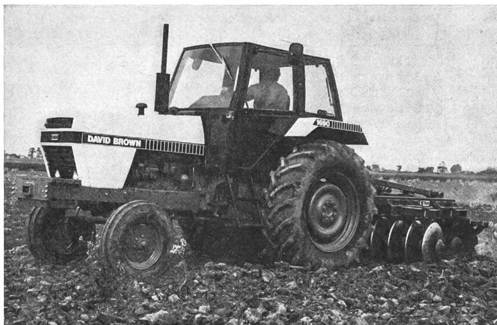
Fig. 3: Le DB 1690 de 103 ch DIN/ 76 kW est équipé d'un moteur à 6 cylindres. Le montage-bloc est main- tenu.
