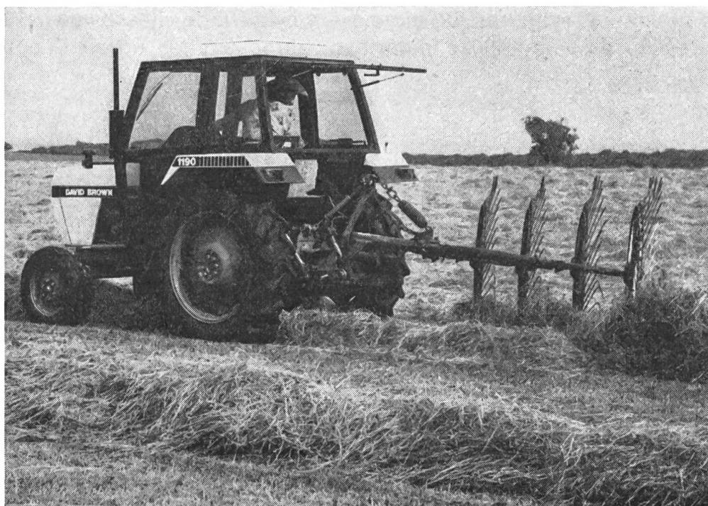
Fig. 1: Les modèles David Brown de la série 90 ont été pourvus d'amples cabines de série montées sur des joints de caoutchouc. Des arceaux de sécurité peuvent être fournis sur demande dans certains pays.
