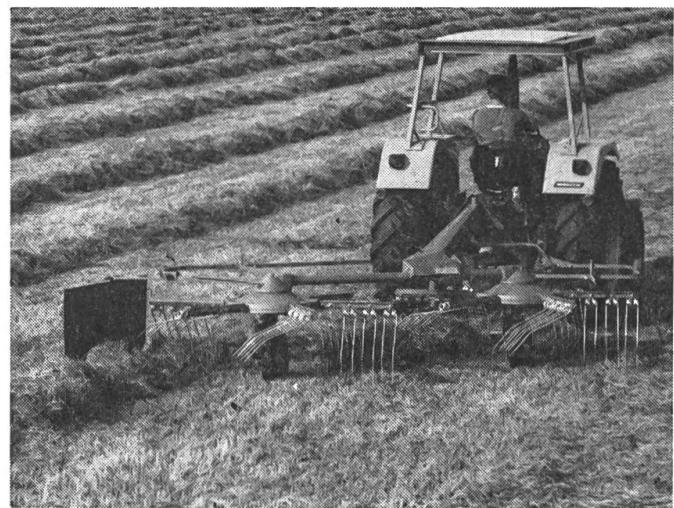
On trouve maintenant sur le marché suisse une nouvelle andaineuse rotative du modèle FAHR KS 200 capable de fournir des performances exceptionnelles. Il s'agit d'une andaineuse à 2 toupies et d'une largeur de travail de 4 m. La largeur de transport ne correspond cependant qu'à 2,90 m. La largeur de travail considérable ne compromet aucunement une excellente adaptation au terrain. Le fourrage saisi par la première toupie est transmis à la suivante avec beau-
