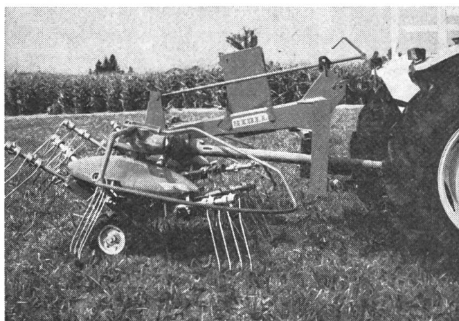
Fig. 1: En position d'épandage, les dents de la faneuse-andaineuse sont rigides comme pour celles du râteau-faneur à toupies.
