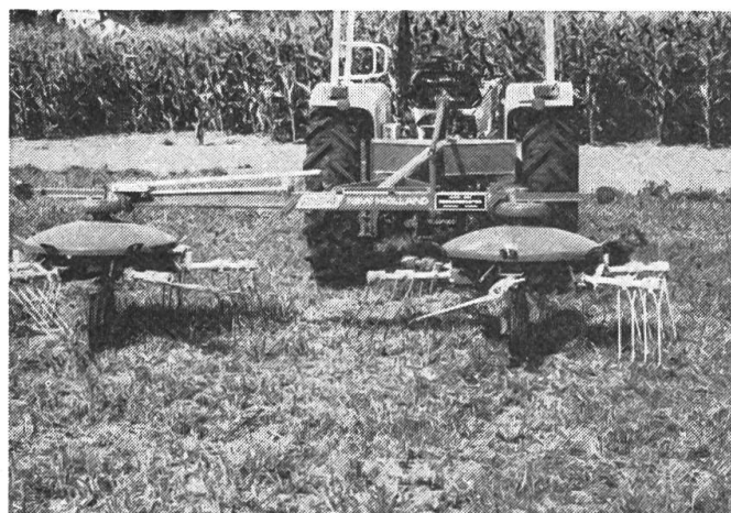
Fig. 2: Afin d'augmenter la capacité de travail, le cadre de la machine peut être allongé.
