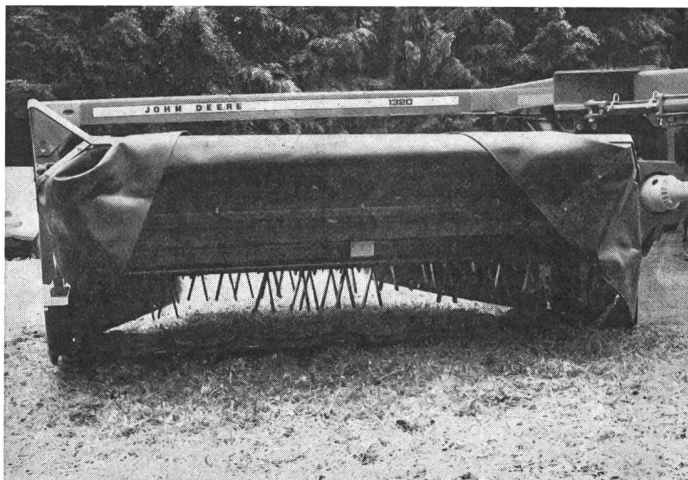
Fig. 1: Des conditionneurs à percussion conviennent surtout pour traiter des fourrages comportant une forte proportion de graminées.
