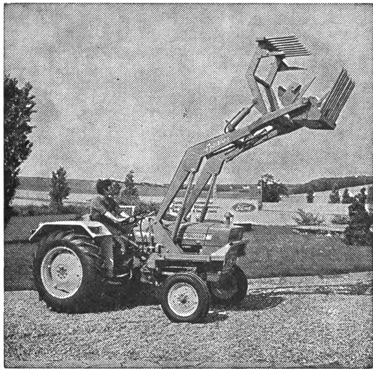
en l'équipant d'un chargeur frontal. Il deviendra ainsi rapidement et facilement un engin de manutention apprécié et idéal.
