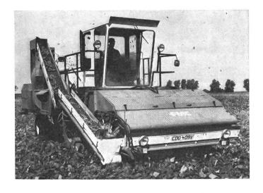
Cette récolteuse de haricots automotrice de construction britannique travaille à une plus grande vitesse et plus efficacement que les modèles classiques.
