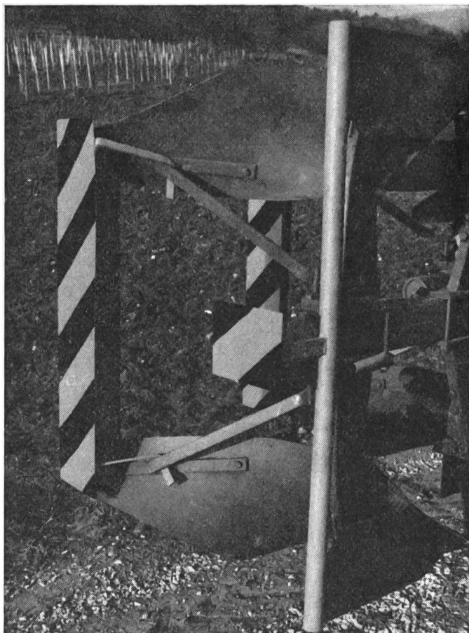
Fig. 4: Il y a plusieurs manières de rendre les parties coupantes moins dangereuses. Un tuyau fendu sur la longueur voulue peut par exemple, faire office de dispositif de protection. Et une couleur très vive attire encore mieux l'attention sur le pivotement de la charrue dans les virages.
