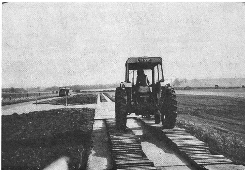
Fig. 3: Les sièges de tracteur sont testés selon des directives internationales sous forme d'unités formant un tout avec le véhicule et ce sur des pistes d'essai normalisées.
