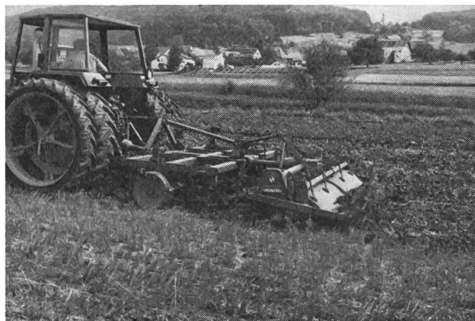
Fig. 2: Une combinaison comportant un cultivateur et une fraise d'une largeur de travail de 2 m exige l'emploi d'un tracteur développant au moins 60 kW (81 ch) au moteur.
