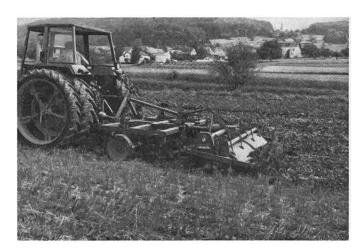
Fig. 2: Une combinaison comportant un cultivateur et une fraise d'une largeur de travail de 2 m exige l'emploi d'un tracteur développant au moins 60 kW (81 ch) au moteur.
