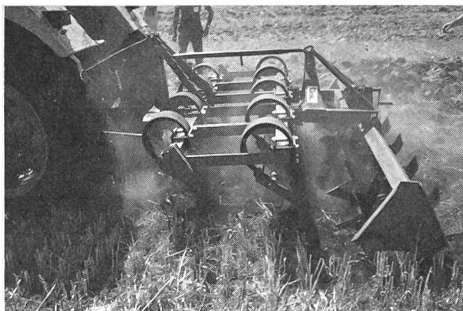
Fig. 1: Combinaison simple: un cultivateur préparatoire suivi d'une herse roulante à lames.
