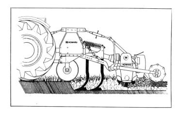
L'emploi de combinaisons d'outils pour la préparation du sol prend de plus en plus d'importance. Cela est dû à des avantages évidents. En effet, l'accouplement en tandem de plusieurs machines appropriées permet d'effectuer en un seul passage un nombre équivalent d'opérations. Il en résulte non seulement une économie de temps de travail et d'énergie sous forme de carburant, mais aussi une réduction du tassement du sol.
