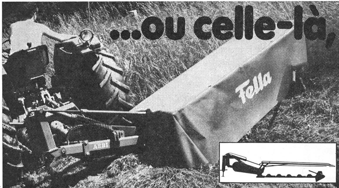
**Faucheuses à disques SM 165 et SM 240** Largeurs de travail 1,65 et 2,40 m. 4 ou 6 disques à 3 couteaux. Commande par courroies trapézoïdales et engrenages dans bain d'huile. Dispositif de sécurité contre l'endommagement. SM 240 avec relevage hydraulique. Grande adaptation au sol et poids minime: idéal pour les exploitations de montagne et dans les terrains accidentés.
