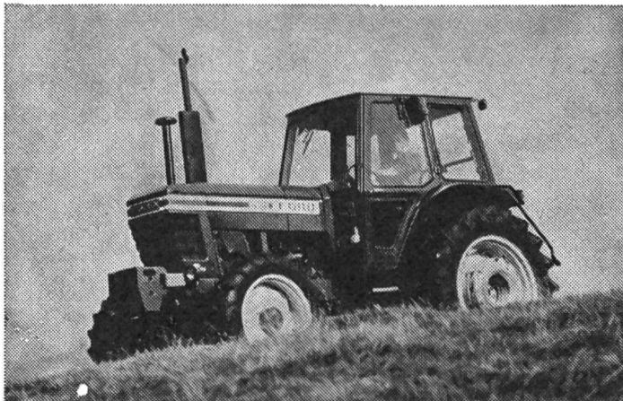
Modèles à 4 & 6 cyl. avec blocage du différentiel automatique. Court rayon de bracage.
