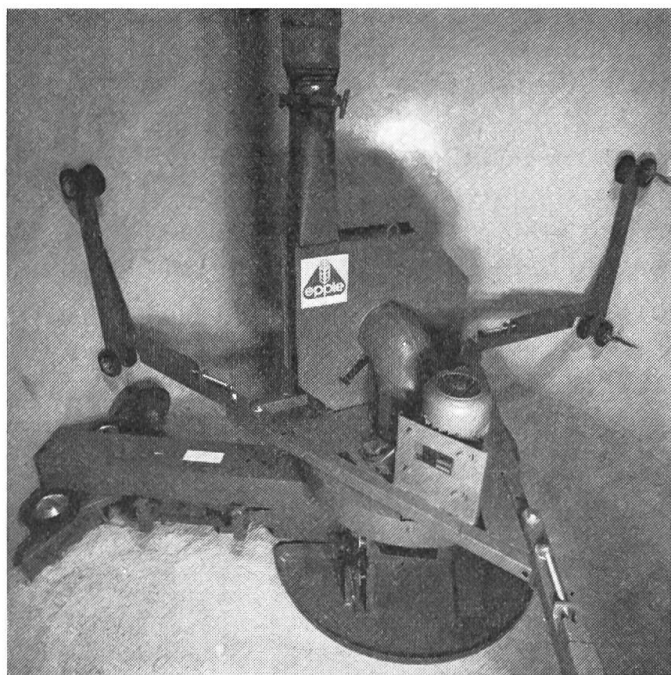
Fig. 2: Désileuse à entraînement central, bras-supports télescopiques (3-bras). Ce système se prête également bien pour le désilage de fourrage par l'autochargeuse à coupe courte.
