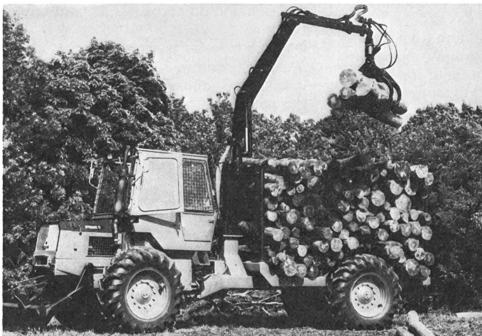
Fig. 2: CEMET — porteur auto- chargeur SM 845 à chas- sis articulé et 4 roues motrices, puissance: 76,5 kW (104,3 ch).
