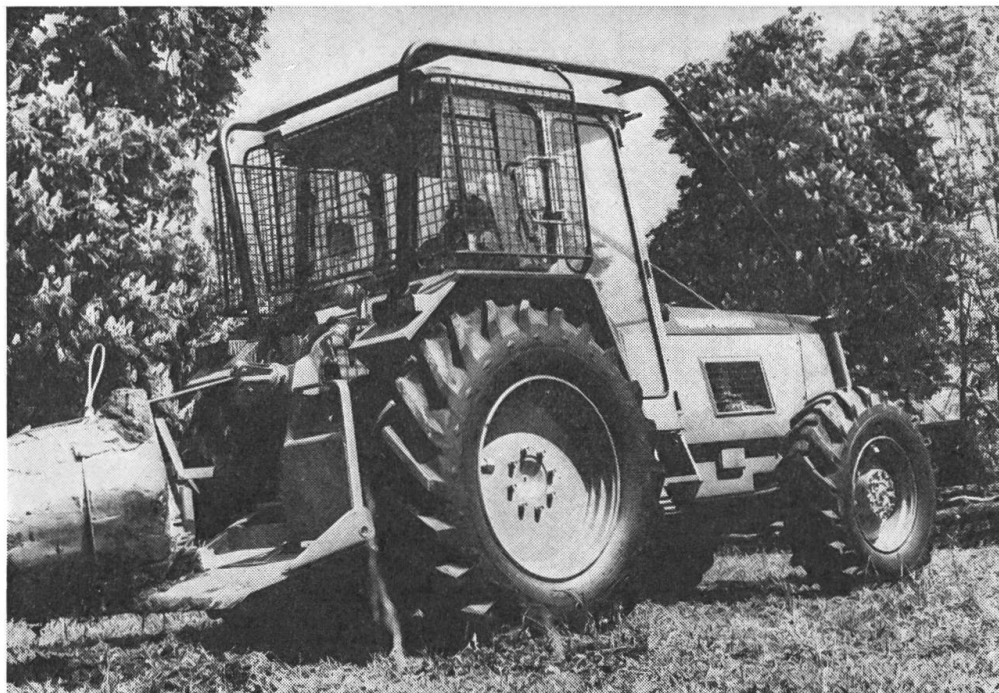
Fig. 1: CEMET — tracteur forestier SM 255 à châssis rigide et 4 roues motrices, puis- sance: 65,5 kW (88 ch).
