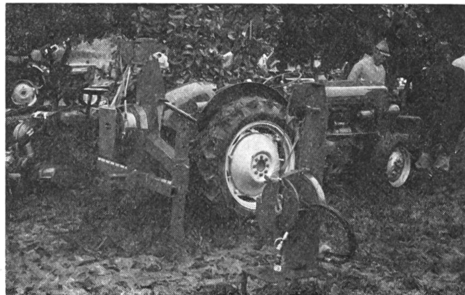
Fig. 4: Treuils soit incorporés ou portés utiles à la fois en sylviculture et en viticulture.
