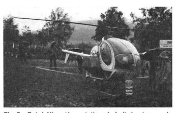
Fig. 5: Cet hélicoptère stationné à l'aérodrome de Lommis (TG) est équipé d'un pulvérisateur à 20 buses opérant à une vitesse de 30 km/heure.
