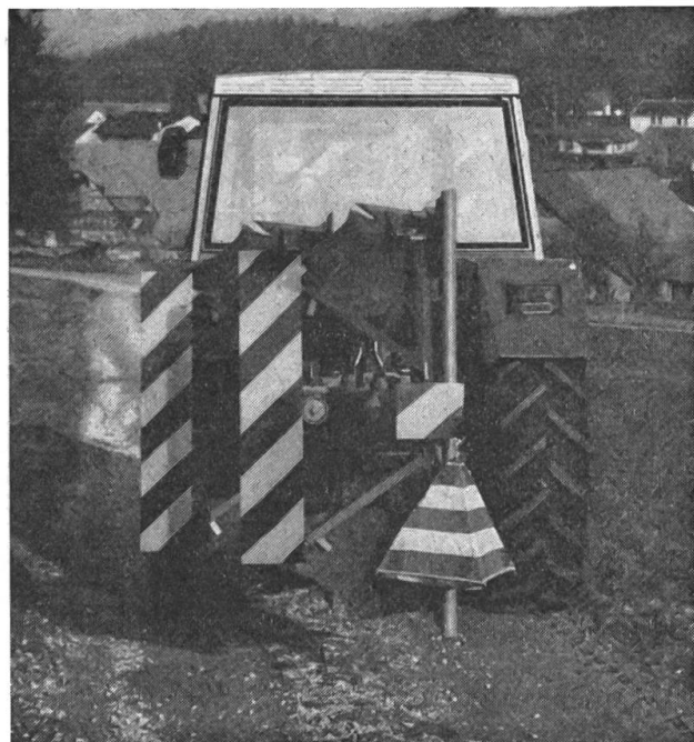
Fig. 3: Avec la charrue, ce sont surtout les socs et coutres qui peuvent devenir dangereux en cas de collision à l'arrière. Il y a donc lieu de parer à ce risque par un système de protection simple et que chaque agriculteur saura exécuter lui-même. En outre, le signal en forme de pyramide ne doit pas être à plus de 90 cm du sol, sinon un feu de gabarit est obligatoire.
