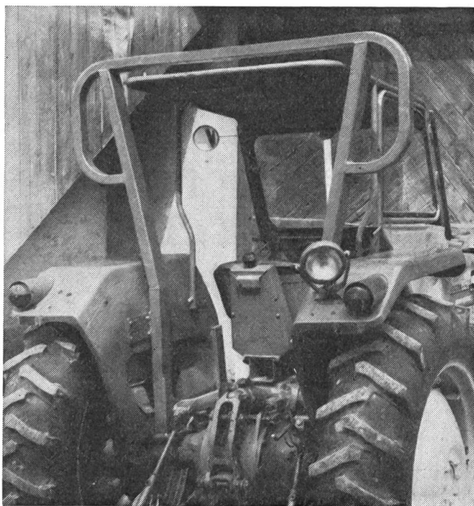
Fig. 7: Arceau de sécurité rigide pourvu d'un abri et à partie supérieure arrondie (système Meyer).
