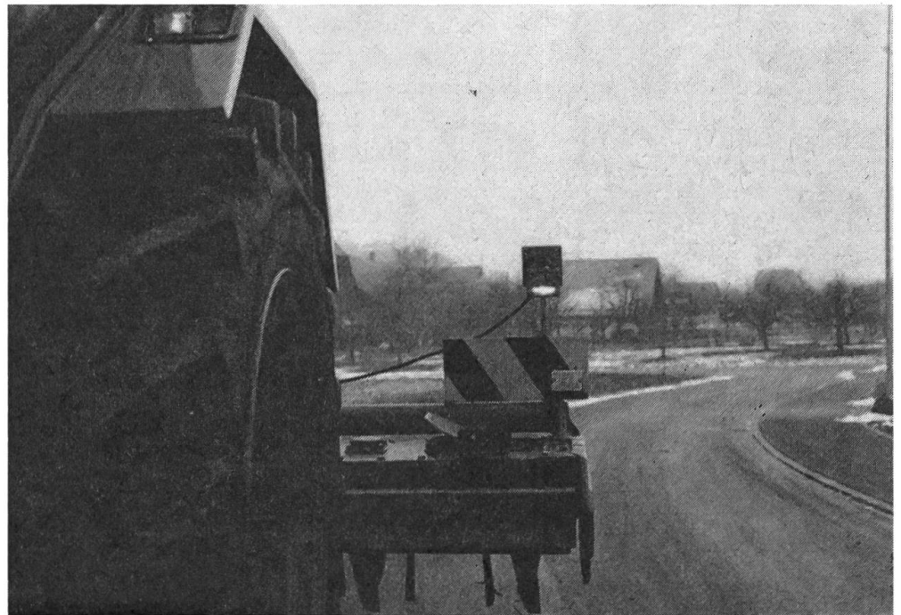
Fig. 6: Le feu arrière se trouve à moins de 10 cm du point le plus extérieur. Un témoin de profil n'est donc pas exigé dans ce cas.
