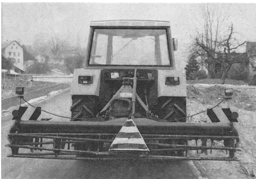
Fig. 4: Pour signaler la largeur d'une machine ou d'un outil porté, les plaques avec raies noires / jaunes et les catadioptrés suffi- sent. Etant donné que l'émotteuse ne présente pas de parties tranchantes, un dispositif de protection n'est pas nécessaire. Le dépassement à l'arrière est rendu visible par un signal en forme de pyra- mide.
