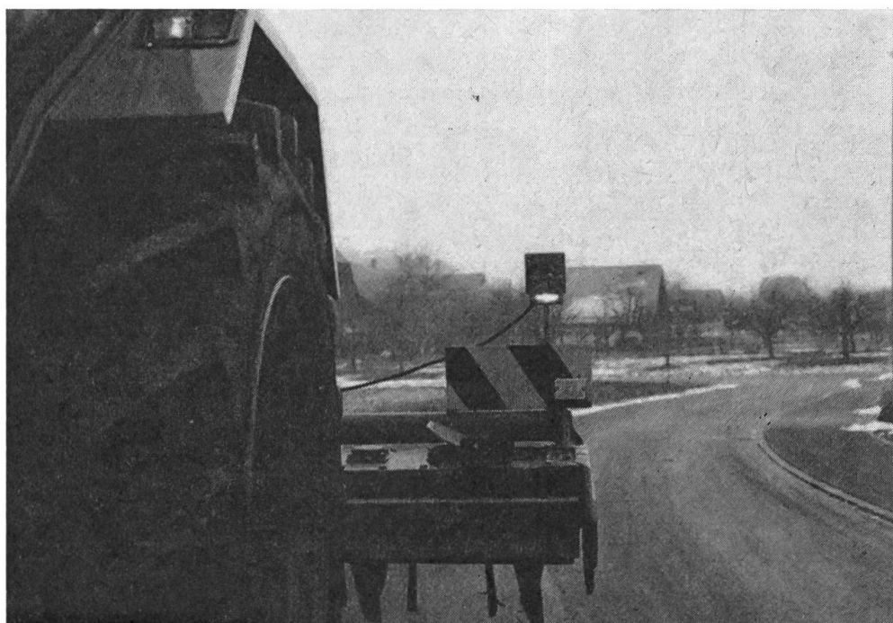
Fig. 6: Le feu arrière se trouve à moins de 10 cm du point le plus extérieur. Un témoin de profil n'est donc pas exigé dans ce cas.
