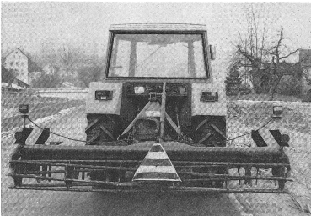
Fig. 4: Pour signaler la largeur d'une machine ou d'un outil porté, les plaques avec raies noires / jaunes et les catadioptrés suffisent. Etant donné que l'émocheuse ne présente pas de parties tranchantes, un dispositif de protection n'est pas nécessaire. Le dépassement à l'arrière est rendu visible par un signal en forme de pyramide.
