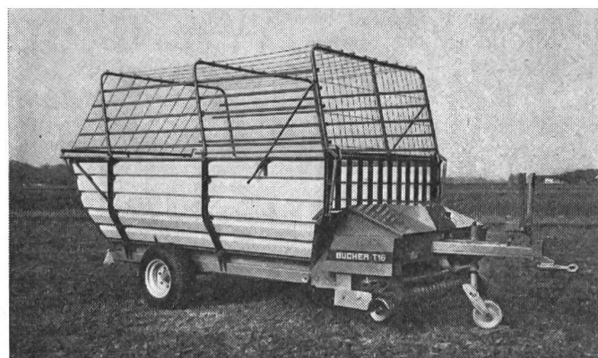
Fig. 1: La nouvelle autochargeuse BUCHER T 16 pour exploitations moyennes. Parois métalliques et dispositif de coupe à 1–8 couteaux.
