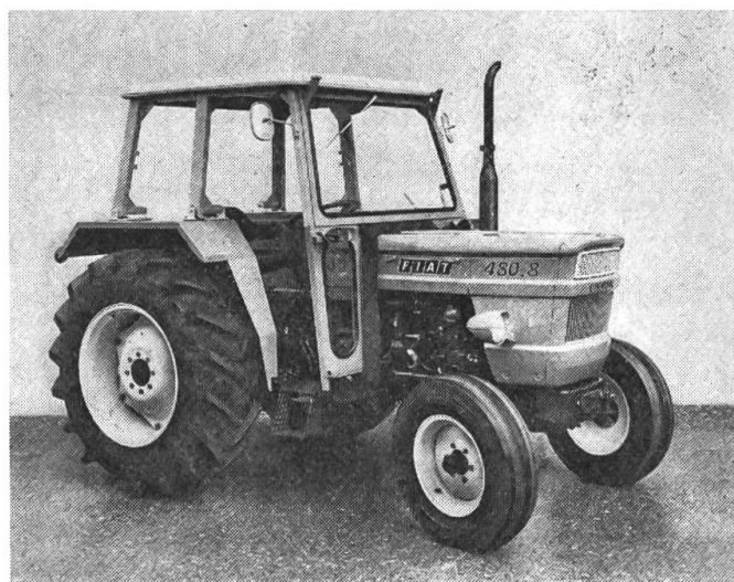
Fig. 2: Un nouveau tracteur FIAT: le modèle 480 à 2 ou 4 roues motrices, 12 marches avant et 3 marches arrière. Il est actionné par un moteur de 46 ch DIN et équipé d'une cabine de sécurité combinable.
