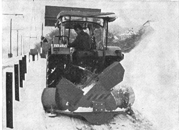
Fixation à 3 points, exécution «tirée et poussée» avec transmission réversible, largeur de travail 2,15 m ou 2,40 m Goulotte de sortie dirigeable à gauche et à droite, ou des deux côtés, excellentes prestations
