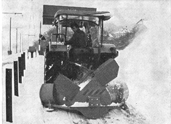
Fixation à 3 points, exécution «tirée et poussée» avec transmission réversible, largeur de travail 2,15 m ou 2,40 m
