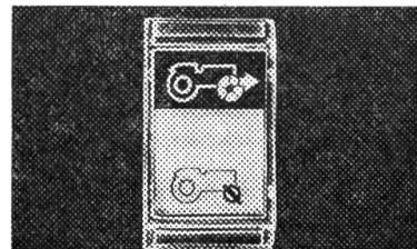
Cet interrupteur pratique embraye ou débraye notre nouveau Pont Avant Mécanique. Un témoin s'allume sur le tableau de bord, quand il est embrayé.
