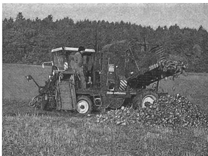
Fig. 4: ITALO-SVIZZERA HM 77 à traction intégrale (toutes les roues motrices). Tous les groupes et appareils de cette machine automotrice sont commandés par hydromoteurs.
