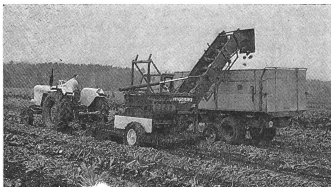
Fig. 8: Chargeuse MOREAU. Sur le type CN 10 (non reproduit ici), les betteraves transportées par la chaîne de nettoyage sont détournées sur le tapis de transbordement au moyen d'un séparateur à vis sans fin. Le type CN 20 (notre photo) est pourvu d'une cage d'écureuil. Cette machine assure un nettoyage meilleur; les verts mis en andains peuvent ainsi présenter un taux d'impuretés un peu supérieur.
