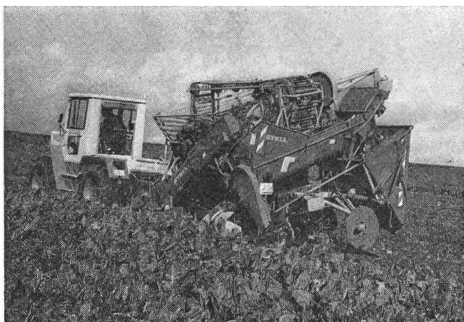
Fig. 3: STOLL V 35. Depuis 1979, cette machine est équipée d'un système automatique de réglage de la force de décolletage. L'élévateur porte-doigt est maintenant remplacé par un élévateur d'alimentation.
