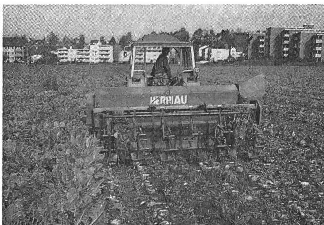
Fig. 6: Effeuilleuse tractée HERRIAU, à 6 rangs. Il existe également des exécutions pouvant être portées à l'avant pour la récolte en deux phases. L'espace demeurant libre à l'arrière est alors disponible pour la défricheuse (fig. 7).
