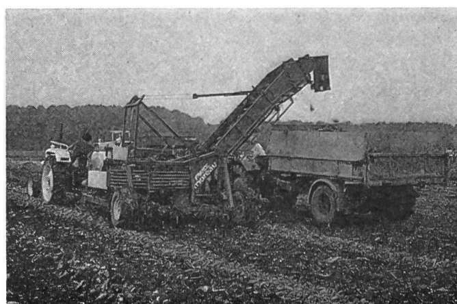
Fig. 8: Chargeuse MOREAU. Sur le type CN 10 (non reproduit ici), les betteraves transportées par la chaîne de nettoyage sont détournées sur le tapis de transbordement au moyen d'un séparateur à vis sans fin. Le type CN 20 (notre photo) est pourvu d'une cage d'écureuil. Cette machine assure un nettoyage meilleur; les verts mis en andains peuvent ainsi présenter un taux d'impuretés un peu supérieur.
