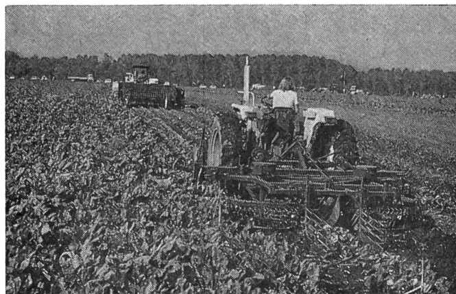
Fig. 7: Défricheuse MOREAU, à 6 rangs. Les différents types de cette machine se distinguent surtout par le genre de leurs socs (socs à disques, socs mobiles latéralement et socs-arracheurs rigides ou vibrants), ainsi que par le nombre de leurs cages d'écureuil (2 ou 3).
