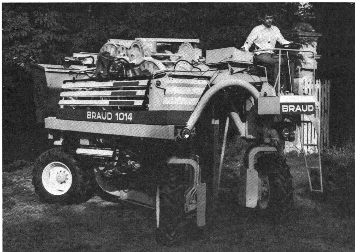
Photo 3: Les machines à vendanger sont des tracteurs enjambeurs sur lesquels il est séduisant d'adapter, hors saison de récolte, différents systèmes d'outils à commande hydraulique.
