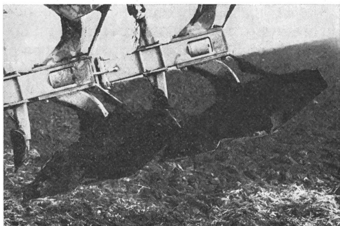
Fig. 13: Dans les sols tourbeux, les charrues conventionnelles sont beaucoup plus sensibles au bourrage que la charrue «à-jour» et la charrue «losange».
