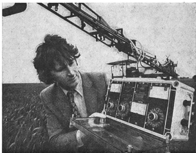
multipliant la distance couverte par la flèche pour obtenir la superficie traitée, en acres ou en hectares. En même temps, la quantité de liquide épandu est mesurée par un débitmètre, et cette quantité est également affichée.
