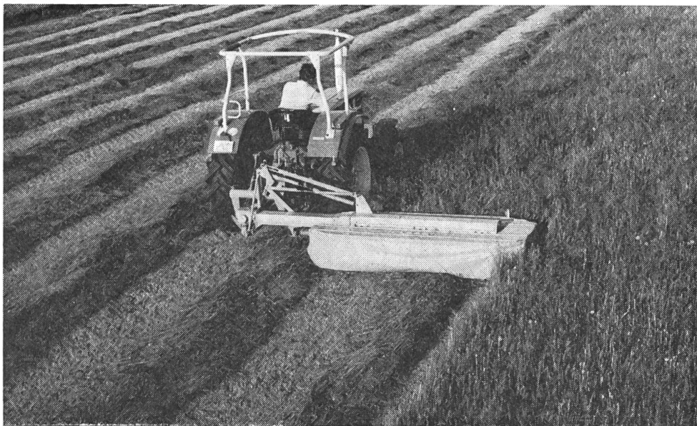
3 dispositifs de coupe rotatifs CLAAS «approuvés par la DLG». La photo représente le modèle VM 25 à largeur de coupe de 2,10 m.
