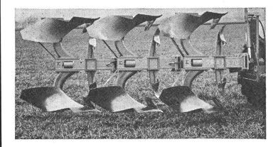
Système de sécurité hydraulique fonctionnant horizontalement et verticalement; il supprime arrêts et manoeuvres de recul.
