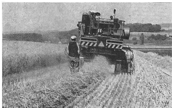
Fig. 14: La détermination des pertes d'égrenage consiste à recueillir dans une bâche la paille sortant de la moissonneuse-batteuse (et la paille courte éventuellement, à part, dans une poche). Puis à mesurer simultanément les temps, le débit du grain et la consommation de carburant. Par la suite, on procède
