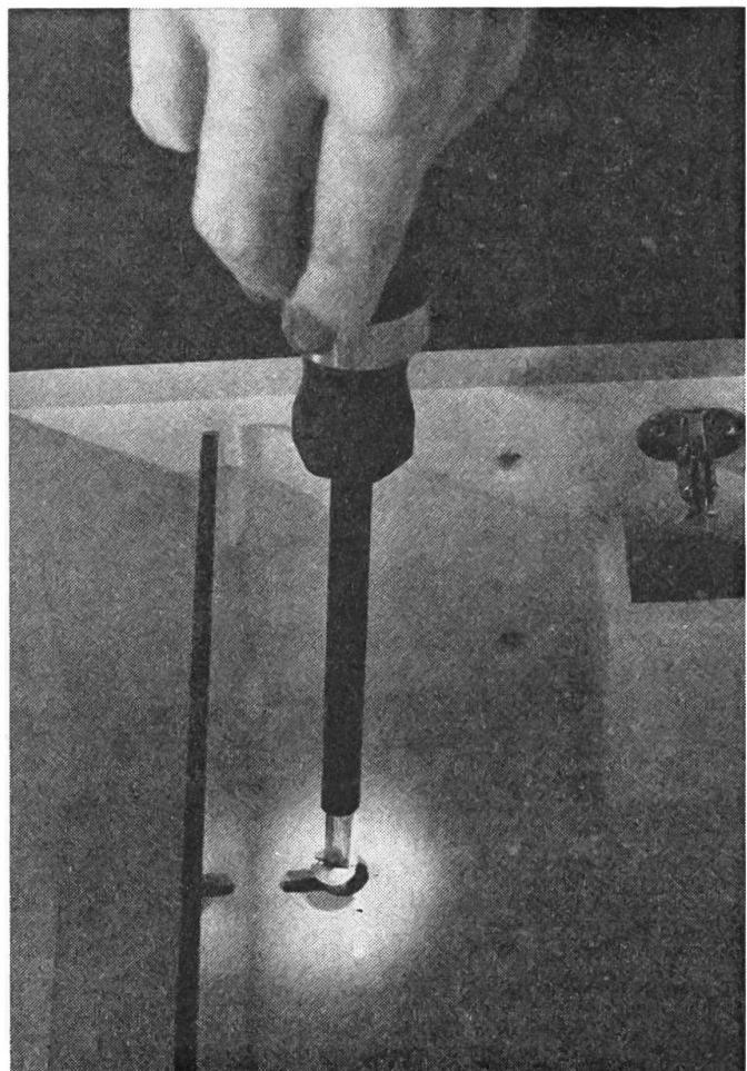
St Asaph (Pays de Galles) qui produit les éléments optiques. On est en train de mettre au point d'autres outils à main à éclairage incorporé grâce à des fibres optiques.
