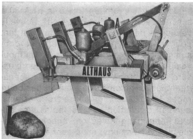
verrouillage mécanique à clichets est un élément important, car il assure un réglage très simple de la charrue et le maintien d'une position uniforme de l'outil sur toute la longueur du sillon.
