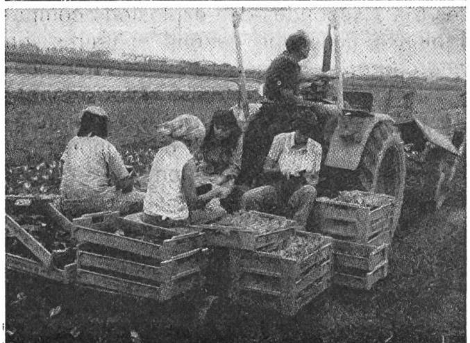
Les interlignes sont variables à partir d'un écartement d'environ 25 cm et les espacements sur la ligne également, mais à partir de 12 cm. La profondeur de plantation peut être maintenue avec une exactitude remarquable entre 2 et 12 cm, assurée à la fois par le rouleau et les roues de support. C'est pourquoi les planteuses Metz-To conviennent pour tous les genres de plantation et
