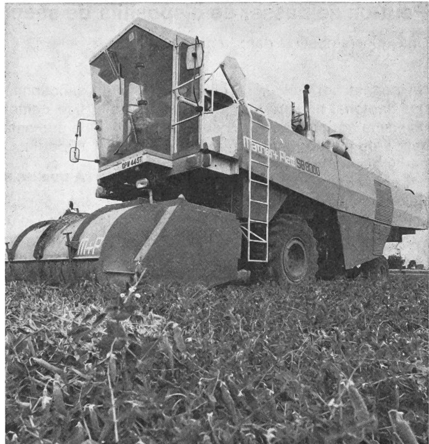
tion — et une commande prioritaire manuelle. L'empattement court et les pneus de «terrassement» assurent une bonne manœuvrabilité et permettent à la machine de fonctionner par tous les temps. La cabine panoramique avec console de commande assure à l'opérateur une excellente vue à la fois de la culture et de l'ensemble rabatteur. Le confort de l'opérateur est de plus assuré en ayant la cabine à une certaine distance du moteur.
