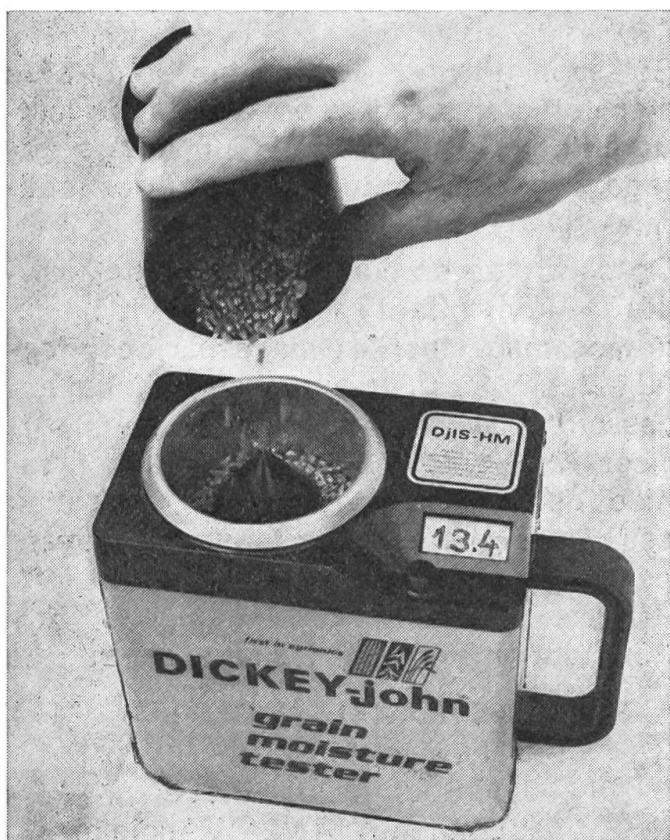
Etant donné que l'appareil ne peut être étalonné directement pour tous les genres de céréales, le taux d'humidité qu'il indique peut être transposé au besoin pour n'importe quelle céréale au moyen d'un tableau fourni à cet effet.
