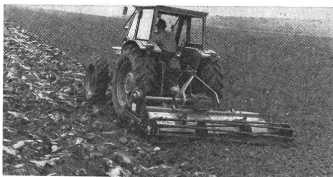
Fig. 7: Pour traiter des sols plutôt humides, l'emploi d'un rouleau émotteur ouvert (Krone) largement dimensionné est avantageux.
