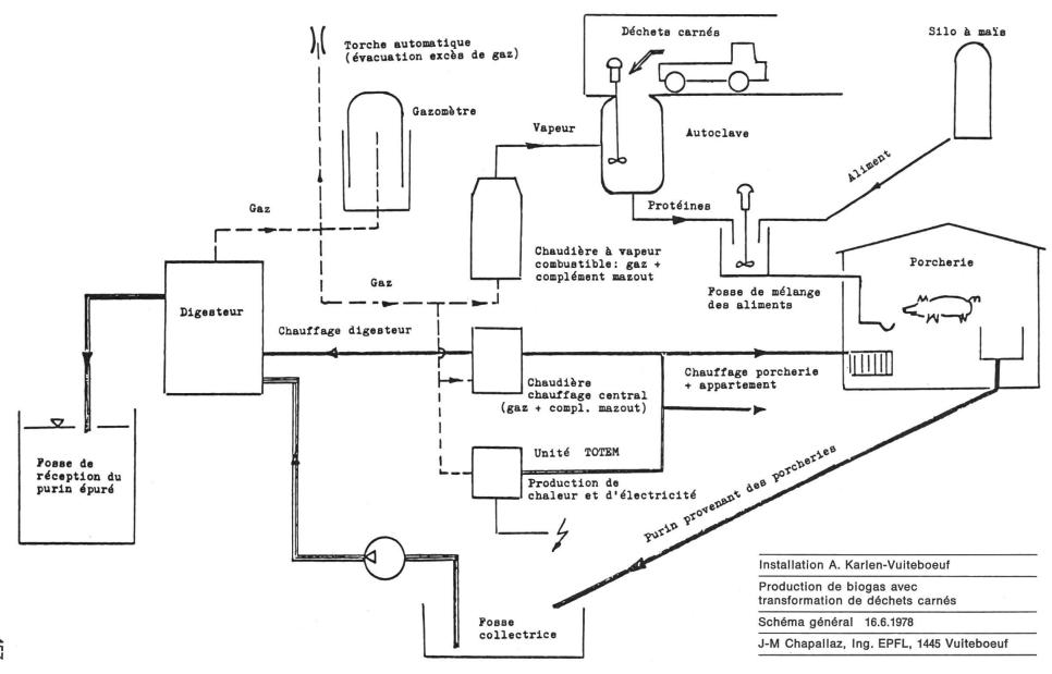
mie d'environ 40'000-50'000 litres de mazout par année (un litre de mazout correspond à 1,6 m³ de biogaz environ). Cette production d'énergie est continue, et exige donc des solutions spéciales pour pouvoir être consommée immédiatement, avec le meilleur coefficient de rentabilité possible.
