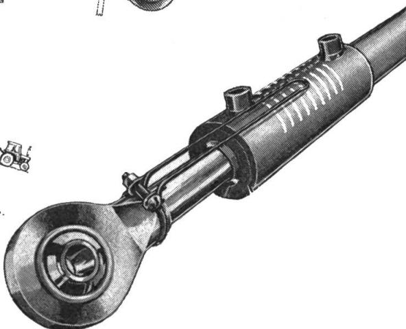
Réglage hydraulique à double action par la commande hydraulique dans votre cabine et près du siège! Plus nécessaire de s'arrêter et de descendre du tracteur!
