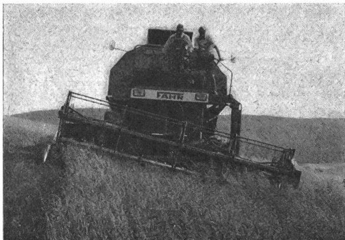
Fig. 1: Dispositif de mise à niveau de la caisse de la moissonneuse-batteuse agissant lorsqu'on roule sur un champ suivant le sens des courbes de niveau.
