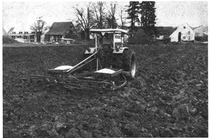
Fig. 5 et 6: Pour la préparation des lits de germination et les semis après une préparation du sol avec d'autres matériels que la charrue, il convient d'employer des instruments et machines dont les outils sont insensibles aux bourrages. Sur les illustrations 5 et 6, on peut distinguer une herse roulante à lames et un semoir pourvu de coutres circulaires.
