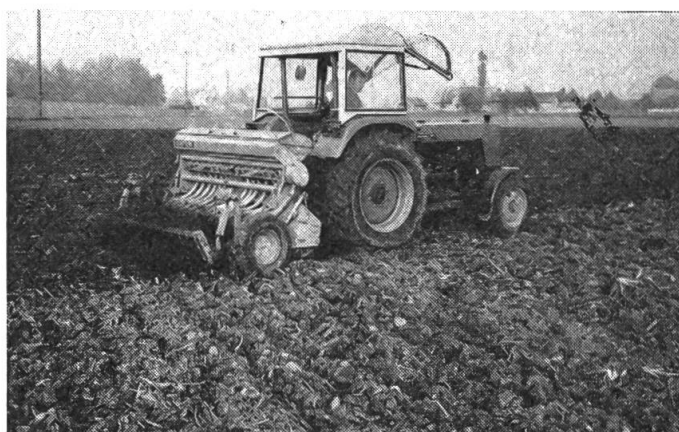
Fig. 8: La préparation dite minimale du sol est effectuée avec une fraiseuse-semeuse. Cette méthode a surtout fait ses preuves pour les cultures dérobées et les cultures de froment.
