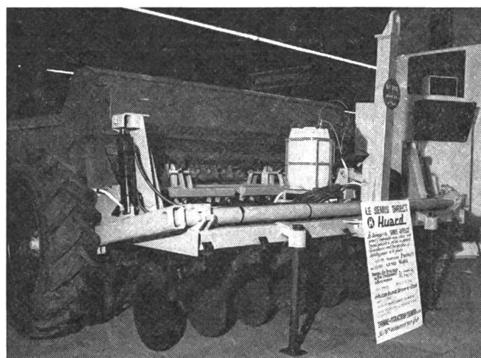
Fig. 7: Des semoirs spéciaux sont proposés aux utilisateurs pour la méthode des «semis directs». On voit ici le semoir spécial Huard.
