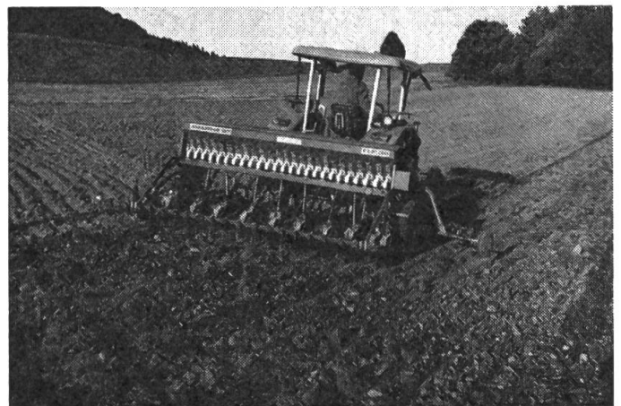
Fig. 5 et 6: Pour la préparation des lits de germination et les semis après une préparation du sol avec d'autres matériels que la charrue, il convient d'employer des instruments et machines dont les outils sont insensibles aux bourrages. Sur les illustrations 5 et 6, on peut distinguer une herse roulante à lames et un semoir pourvu de coutres circulaires.
