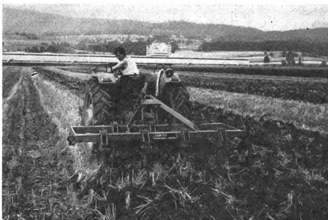
Fig. 1: Le chisel (cultivateur sous-soleur) à dents rigides du genre ciseau est l'instrument qui convient le mieux pour effectuer la préparation du sol sans recourir à la charrue.
