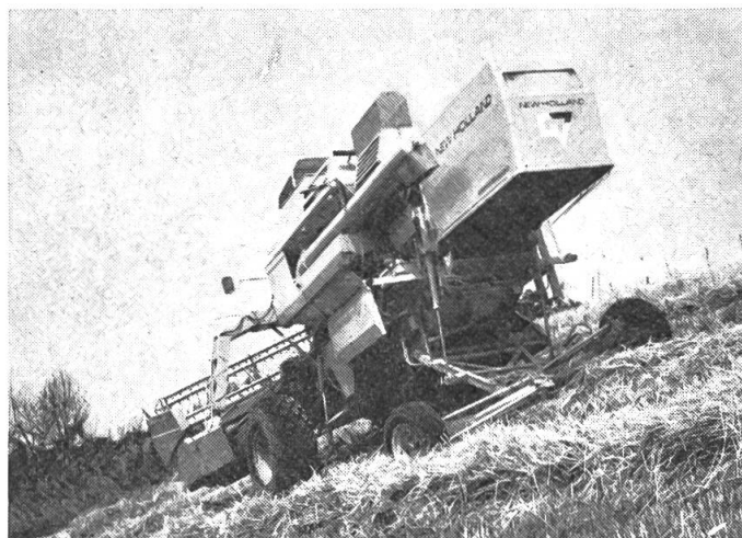
Fig. 7: Modèle New-Holland avec dispositif complet d'équilibrage. La machine photographiée ici est munie de pneus à cannelures losanges. Ces profils devraient offrir une meilleure adhérence au sol que les pneus à profils barrettes, spécialement en pente, sur des sols de régions à précipitations atmosphériques limitées. Sur des sols humides, par contre, l'effet d'autonettoyage est moins bon, d'où danger de glissement). Toutes les machines à dispositif d'équilibrage ont donc été vendues, en Suisse, avec des pneus traditionnels.
