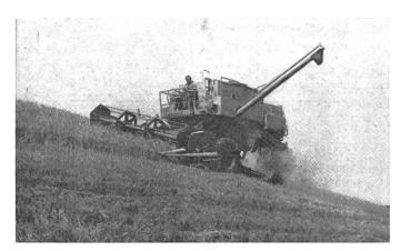
Fig. 5: Modèle Claas Do 85 H avec dispositif complet d'équilibrage. Les organes batteurs restent en position horizonale jusqu'à un certain taux de déclivité, aussi bien dans l'axe longitudinal que transversal. Toutes les machines avec dispositifs spéciaux sont munies de soupapes de sécurité de blocage, pour éviter une rupture de la conduite hydraulique.
