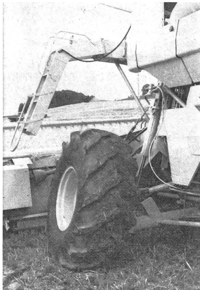
Fig. 6: L'essieu avant à suspension pendulaire de la moissonneuse-batteuse New-Holland, à dispositif complet d'équilibrage. L'illustration montre également les cylindres hydrauliques et la traction par câble pour la commande de la barre de coupe.
