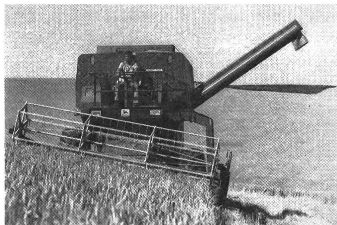
Fig. 2: Modèle John Deere 965 H, avec dispositif latéral, jusqu'à 20% de déclivité. Par sa suspension de parallélogramme, les roues arrière restent toujours en position verticale.
