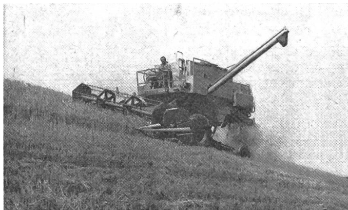
Fig. 5: Modèle Claas Do 85 H avec dispositif complet d'équilibrage. Les organes batteurs restent en position horizontale jusqu'à un certain taux de déclivité, aussi bien dans l'axe longitudinal que transversal. Toutes les machines avec dispositifs spéciaux sont munies de soupapes de sécurité de blocage, pour éviter une rupture de la conduite hydraulique.
