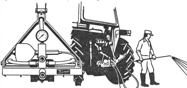
Vous avez ainsi à bien meilleur compte un nettoyeur haute pression, puissant et mobile. Il suffit de quelques gestes pour brancher l'appareil KLINETT, qui offre les mêmes avantages que les modèles normaux: il nettoie, désinfecte, sable. S'emploie aussi pour blanchir les écuries à la chaux.
