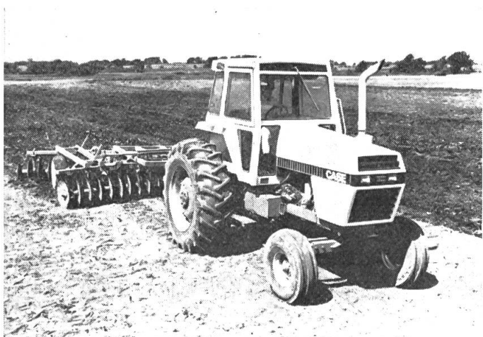
Fig. 1: Le nouveau tracteur 2290 de David Brown / Case, équipé d'une cabine climatisée de sécurité, ayant un faible niveau de bruit et une transmission à 12 vitesses.
