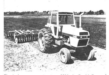
Fig. 1: Le nouveau tracteur 2290 de David Brown / Case, équipé d'une cabine climatisée de sécurité, ayant un faible niveau de bruit et une transmission à 12 vitesses.
