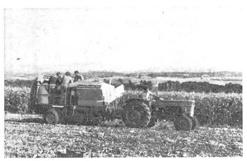
Fig. 1: L'arracheuse-ramasseuse de pommes de terre (machine à récolte totale) est souvent utilisée collectivement dans les **petites communautés.**
