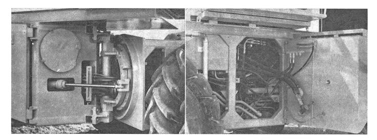
Détail de l'articulation avec axe vertical de pivotement et couronne verticale de débattement du bloc avant. Ce dernier abrite le système de refroidissement du circuit hydraulique. Au-dessus de la sortie de vérin est placée une trappe de visite mais pour un accès plus large, il suffit de dévisser un goujon pour faire pivoter l'un des réservoirs de fluide. Le moteur thermique est également accessible par la plate-forme.
