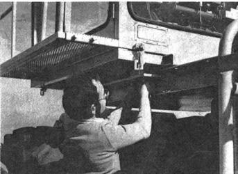
Dans la cabine, on aperçoit les voyants de contrôle au plafond. Pour le déplacement, M. Bidon débloque les plaques porte-goujons (2 écrous de chaque côté) qui assujettissent la cabine, puis la fait glisser sur les rails de la plate-forme.
