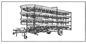
Ramasseuse de balles Fella Perfekt 125. Charge et décharge 125 balles à haute pression.
