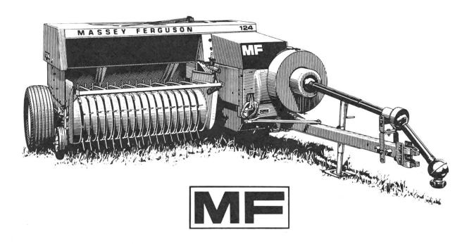
Les presses-ramasseuses MF sont équipées de noueurs avec dispositif de sécurité, donc point de réglage.
