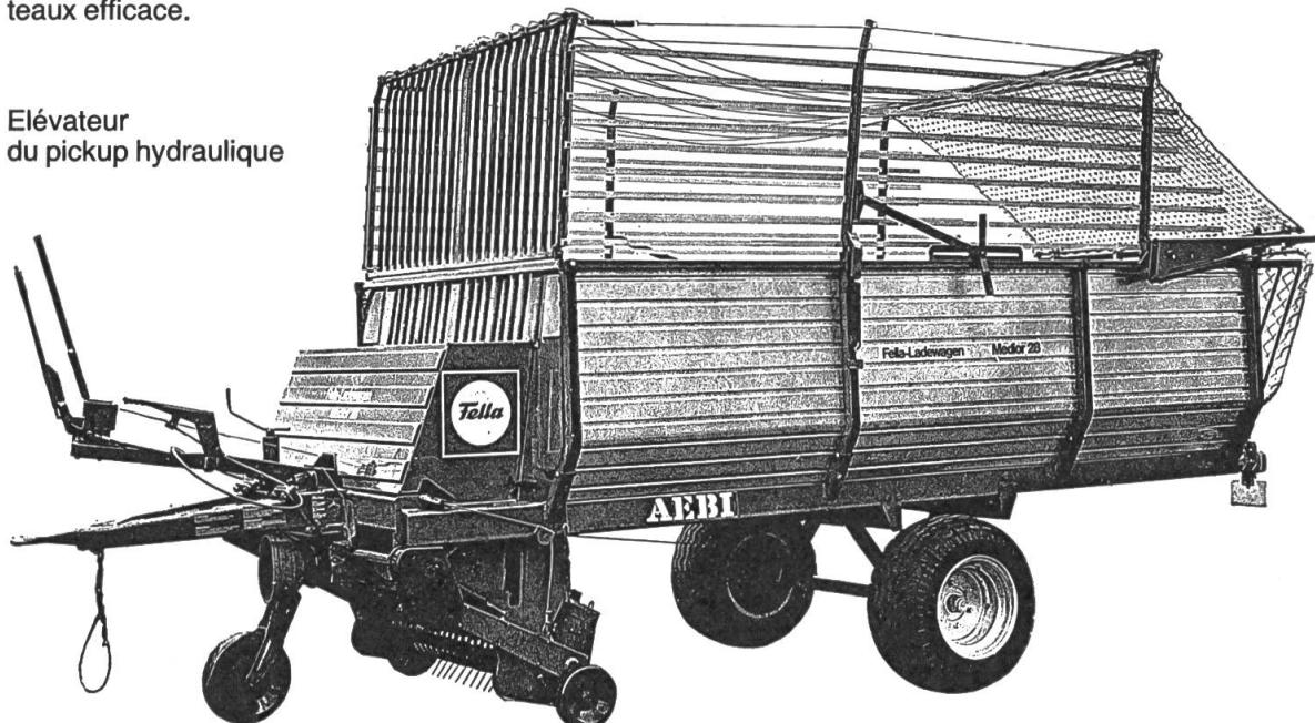
Système d'alimentation robuste à tiges de poussée travaillant régulièrement. Un quart des couteaux seulement coupent en même temps.
