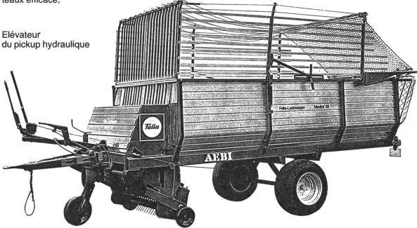
Système d'alimentation robuste à tiges de poussée travaillant régulièrement. Un quart des couteaux seulement coupent en même temps. Différentes dimensions de pneus, sur demande essieu-tandem.
