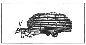
Autochargeuses surbaissées Fella Peggy. 2 modèles pour 18 et 22 m³ de fourrage sec, avec 12 couteaux au maximum.
