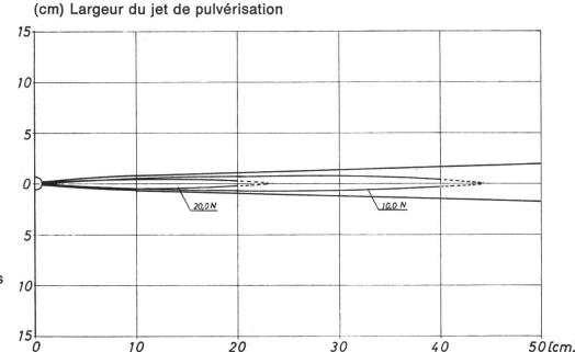
Fig. 3: Courbes d'effets dynamiques égaux compris dans la coupe longitudinale du jet d'eau, à proximité d'une buse bâton.
