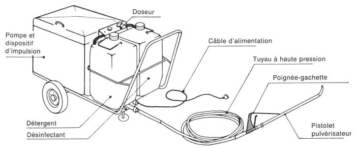
Fig. 1: Structure schématique d'un nettoyeur à haute pression.
