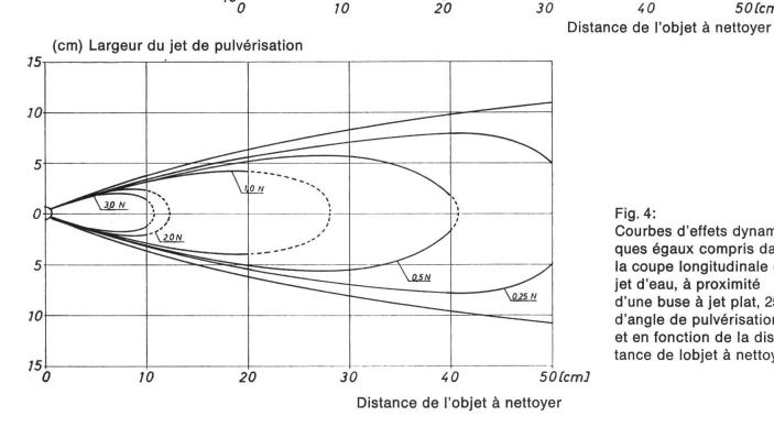
Fig. 4: Courbes d'effets dynamiques égaux compris dans la coupe longitudinale du jet d'eau, à proximité d'une buse à jet plat, 25° d'angle de pulvérisation et en fonction de la distance de lobjet à nettoyer.
