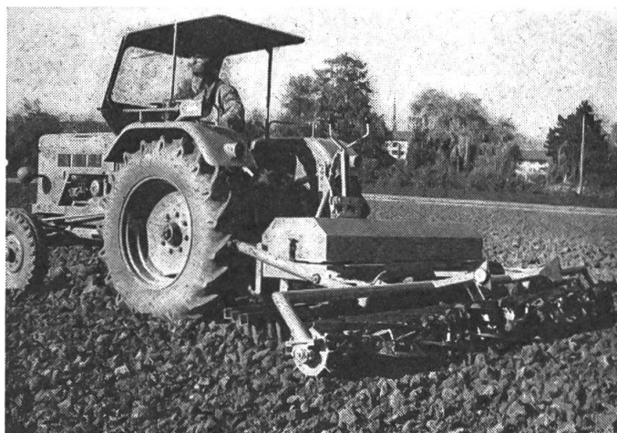
Fig. 14: Les possibilités d'emploi de la herse à barres oscillantes se limitent aux terres légères à mi-lourdes, c'est-à-dire là où les instruments tractés et de prix modique peuvent être également utilisés.
