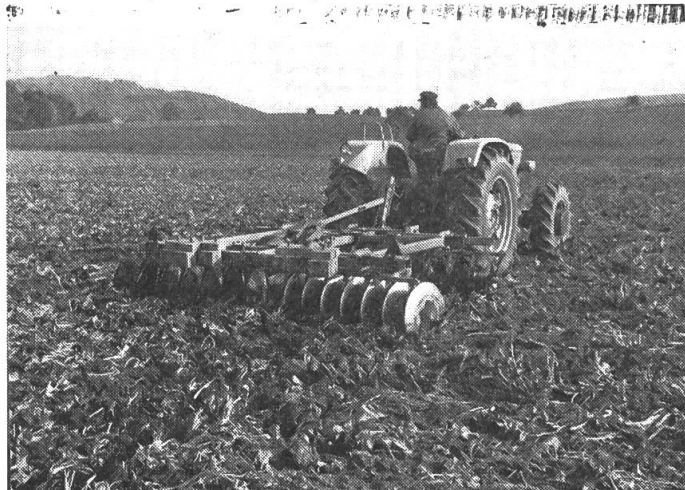
Fig. 7 et 8: Les chisels de n'importe quel genre, de même que les pulvérisateurs à disques, peuvent être employés pour les déchaumages, et, dans certaines conditions, également pour la préparation des lits de germination. En accouplant une fraiseuse derrière le chisel, on a la possibilité de préparer le champ pour les semis pratiquement en un seul passage. Cette combinaison de matériels exige, il est vrai, un tracteur d'une puissance supérieure à 80 ch (5 q/kW).
