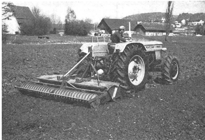
Fig. 11 et 12: L'utilisation de machines actionnées par la prise de force, telles que la fraiseuse ou la herse à toupies, est spécialement indiquée dans les terres lourdes.
