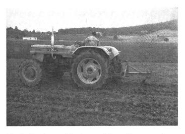
Fig. 2: Il est possible de remédier efficacement aux compressions du sol qui se produisent en profondeur en mettant en œuvre une charrue draineuse (charrue-taupe).
