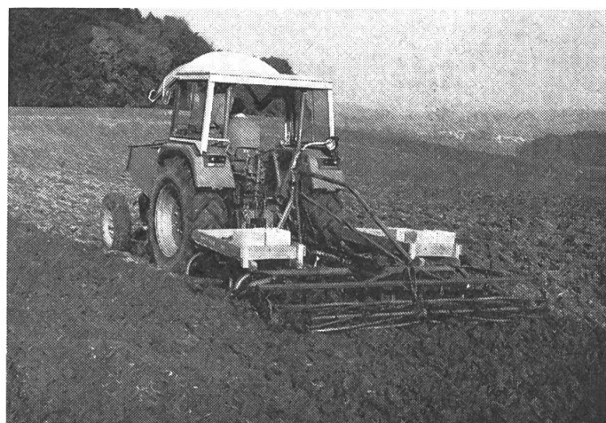
Fig. 9: La herse roulante à lames est principalement employée avec succès pour la préparation des lits des semences en automne.
