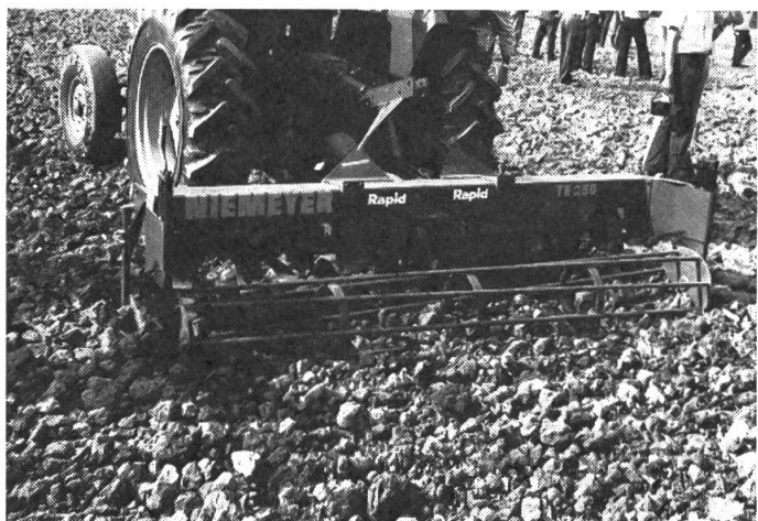
Fig. 13: La herse à étoiles oscillantes, qui laisse derrière elle une couche superficielle de structure assez grossière, convient particulièrement bien pour les semis d'automne.
