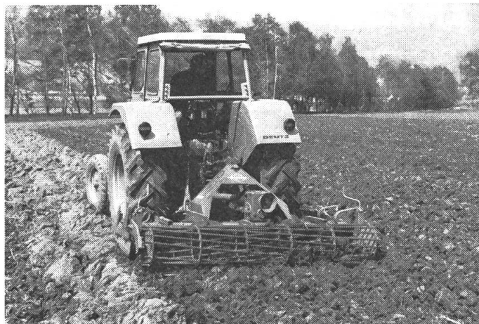
Fig. 11 et 12: L'utilisation de machines actionnées par la prise de force, telles que la fraiseuse ou la herse à toupies, est spécialement indiquée dans les terres lourdes.
