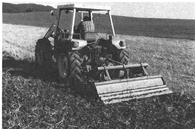
Fig. 5 et 6: Pour la préparation du sol sans usage de la charrue, certains chisels à dents du type ciseau et machines à bêches ont fait leurs preuves.
