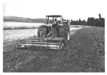
Fig. 7 et 8: Les chisels de n'importe quel genre, de même que les pulvériseurs à disques, peuvent être employés pour les déchaumages, et, dans certaines conditions, également pour la préparation des lits de germination. En accouplant une fraiseuse derrière le chisel, on a la possibilité de préparer le champ pour les semis pratiquement en un seul passage. Cette combinaison de matériels exige, il est vrai, un tracteur d'une puissance supérieure à 80 ch (5 q/kW).
