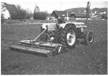
Fig. 11 et 12: L'utilisation de machines actionnées par la prise de force, telles que la fraiseuse ou la herse à toupies, est spécialement indiquée dans les terres lourdes.
