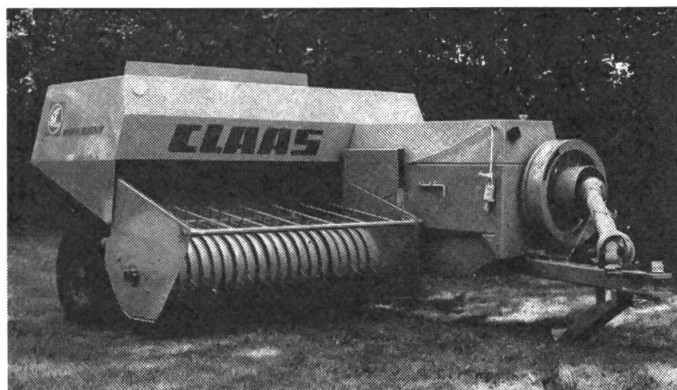
Fig. 5: La ramasseuse-presse CLAAS Markant 55 à haute densité a un tambour ramasseur (pick-up) d'une longueur de 1 m 65 et comporte une commande sans chaînes pour les organes à fonctionnement synchronisé.
