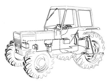
Le système de régulation électrohydraulique du dispositif de relevage réalisé par Bosch pour les tracteurs de construction moderne.
